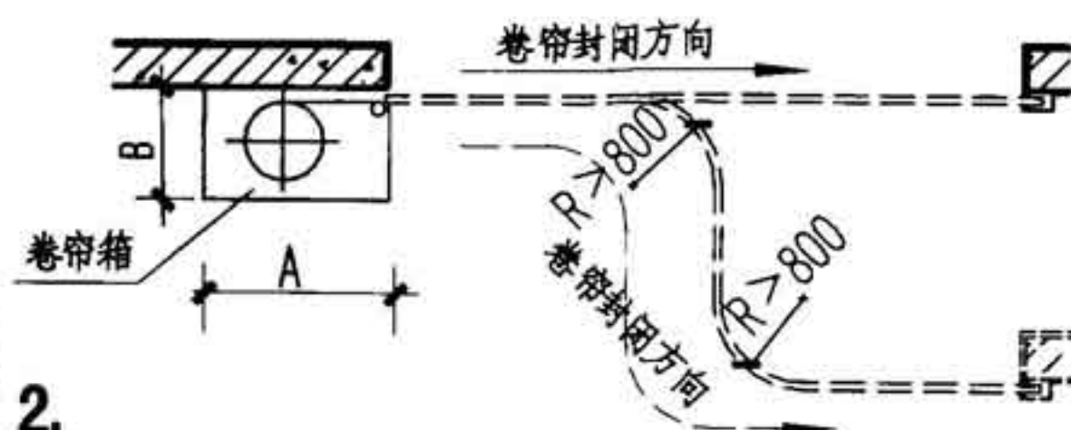
TGFYJx 侧向钢质特级防火卷帘(单向)平面示意图
